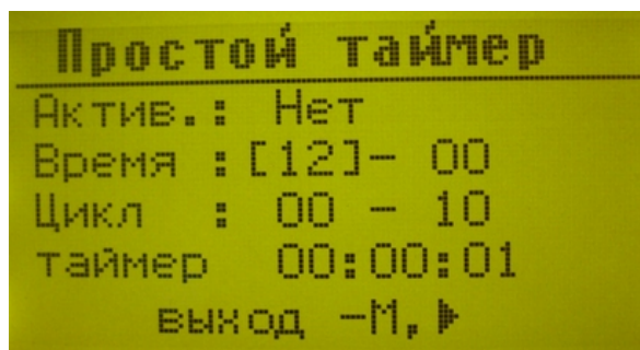
Рисунок 27. Настройки простого таймера.
