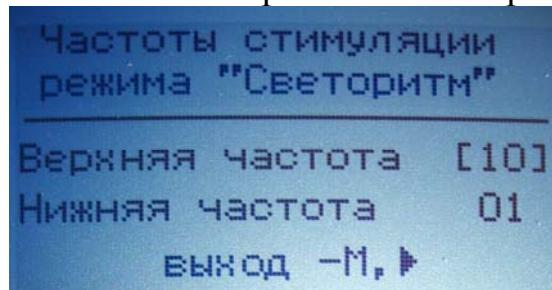
Рисунок 32. Настройка пользовательских частот стимуляции для «Светоритма»
